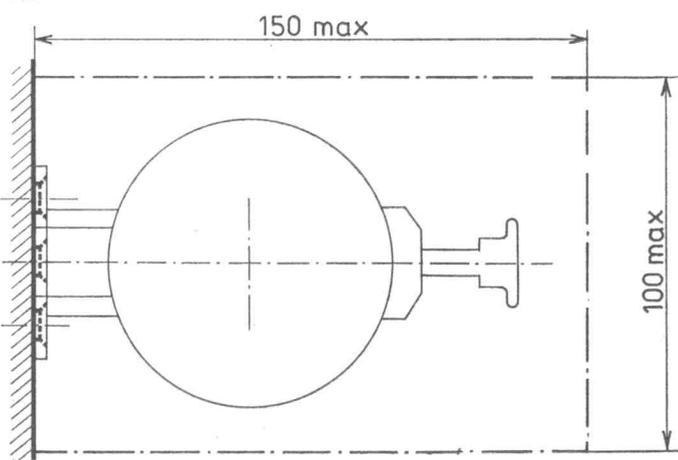
\* La fixation du distributeur doit être réalisée avec des pièces (vis, boulons, rivets, etc.) de diamètre nominal 6
